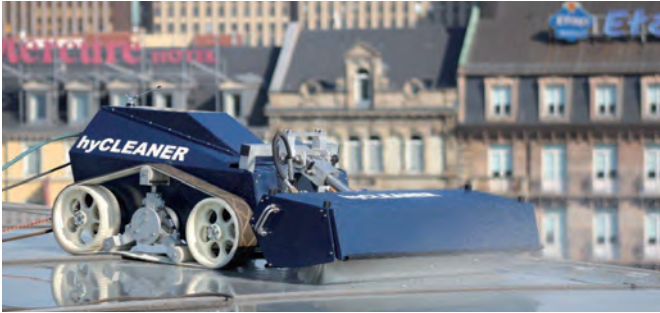
Reinigungsmaschinen für Glasdächer müssen robust und gleichzeitig leicht sein. Hier das Vorgängermodell hyCLEANER® blue – EVO II beim Einsatz auf dem Dach des Straßburger Hauptbahnhofs.
