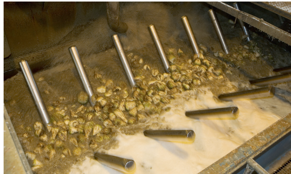
Nach der Anlieferung werden die Rüben zunächst gewaschen und zerkleinert
