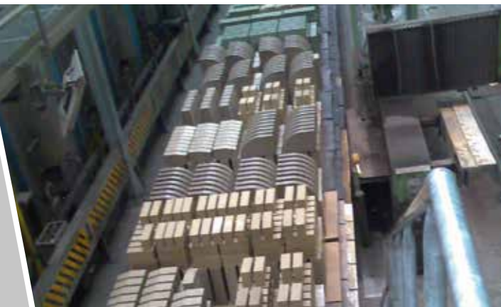
Auf dem Weg zum Tunnelofen: Die Steine wurden nach den Vorgaben des Setzmustergenerators von MuM optimal auf die Wagen geladen.
