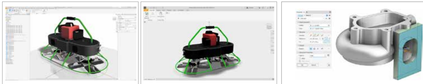
Wie praktisch! Beim neuen Inventor gibt es den Nur-Lese-Modus (rechts) zur reinen Information. Die erweiterte Eigenschaften-Anzeige bietet direkten Zugriff auf wichtige Befehle.
